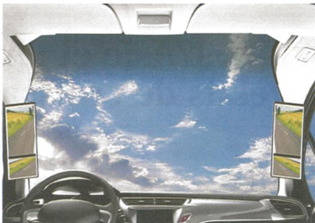
Vision Systems s'apprête à mettre sur le marché un autre produit de rupture qui remplacera le rétroviseur traditionnel par des caméras numériques et des écrans intérieurs.
