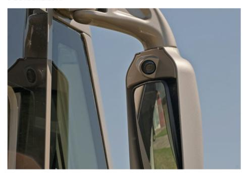
Vision Systems propose une solution innovante pour réduire les risques d'accidents liés au problème de la rétrovision et de l'angle mort, particulièrement importants sur les camping-cars longs.
