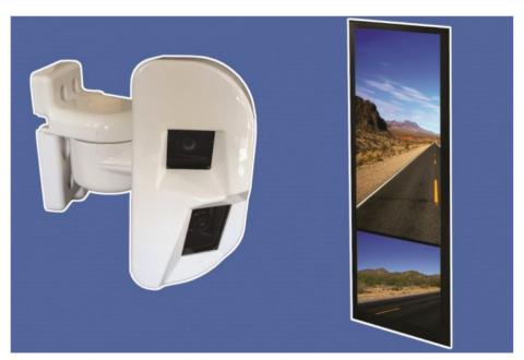
Vision Systems remplace les rétroviseurs par des caméras haute-définition et des écrans intérieurs. © Vision-Systems
