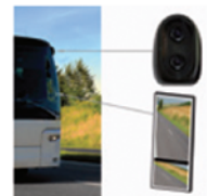
Une petite caméra est destinée à remplacer les rétroviseurs pour les cars grand tourisme.
